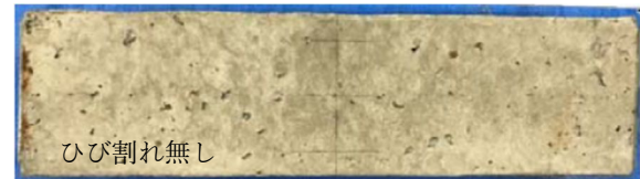
(a) Type1-2b グラウト充填の供試体
