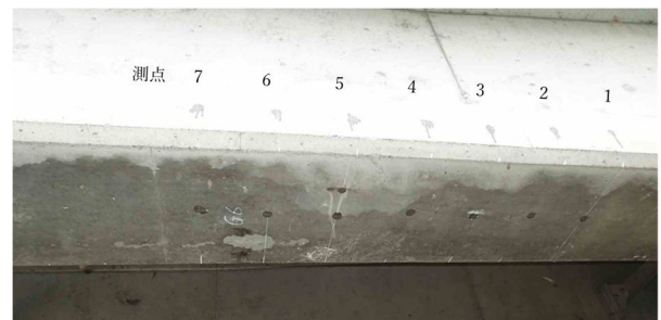
図 3-12 G4 超音波法の調査結果
