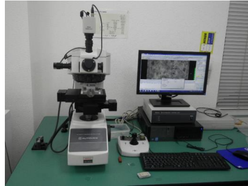
図-4 ビッカース硬度試験状況
