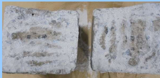
1日養生後のひび割れ内部状況
