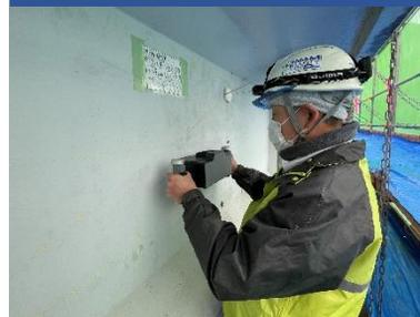
アレイセンサから発信される超音波の横波を利用して、鉄筋や空洞、ひび割れ、PCグラウト充填度を調査します。
