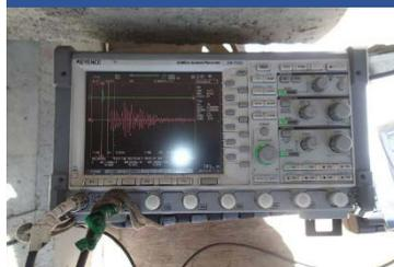
横締めPCケーブルに発生させた弾性波の伝播速度と振幅を解析し、グラウト充填度を推定します。
